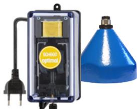
Der Zubehörsatz Lufteinperlung ist eine kostengünstige Lösung um das Niveau in Abwasseranlagen zu erfassen. Das System lässt sich mit unseren Pumpensteuerungen kombinieren. Der Artikel besteht aus dem Zubehörsatz Staudruck s.o. und 0,5 m Luftschauch 4/6, T-Stück, Rückschlagventil und Membranpumpe. Der Zubehörsatz Lufteinperlung ermöglicht den Betrieb des Systems ohne Nachlaufzeit.
