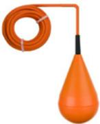
Der NIVA Niveauregler MS 1 ist speziell zum Einsatz in Kläranlagen und Pumpstationen mit feststoffbelasteten Flüssigkeiten wie z. B. Roh-Abwasser geeignet. Schwimmerschalter werden eingesetzt, um die Pumpen über Ein- und Ausschaltniveau zu betreiben. Weiterhin finden sie Verwendung beim Trockenlaufschutz oder Hochwasseralarm. Die Schwimmerschalter lassen sich mit unseren Steuerungen kombinieren.
