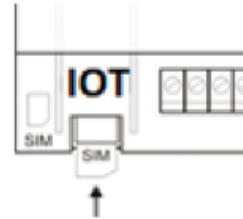
Die SIM-Karte wird so wie in der Abbildung oben ca. bis zur Hälfte mit den Kontakten nach unten in den SIM-Karten-Halter geschoben.
